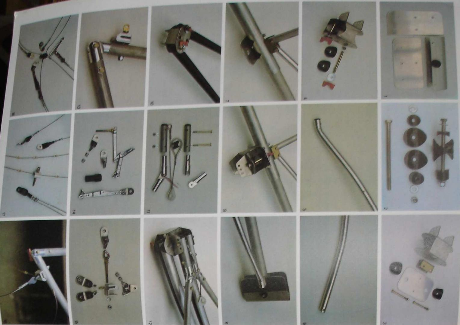
Perçer perpendiculairement à 3,5 cm du bord, un trou de 6 mm de diamètre et poser un embout plastique.
