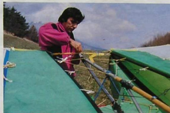
Un système d'étrépage par sangles et leviers assure une forte tension de la voile sur la structure.
