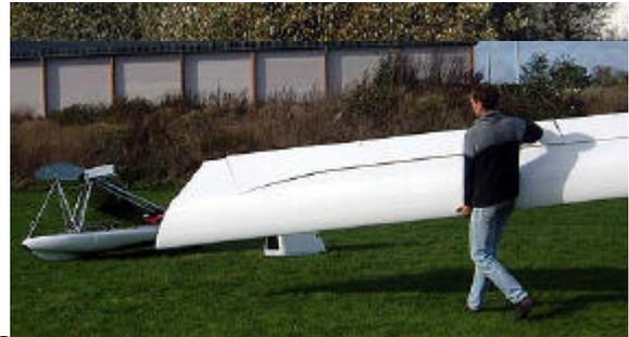
18. Sortir environ 2/3 de l'aile. Prendre l'aile par-dessous, à hauteur du centre de gravité, une main sur le bord d'attaque, l'autre sur le bord de fuite. Sortir l'aile du conteneur.
