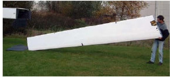
4. Déposer le bout d'aile devant le conteneur, sur un tapis de protection déposer préalablement, puis saisir l'emplanture.
