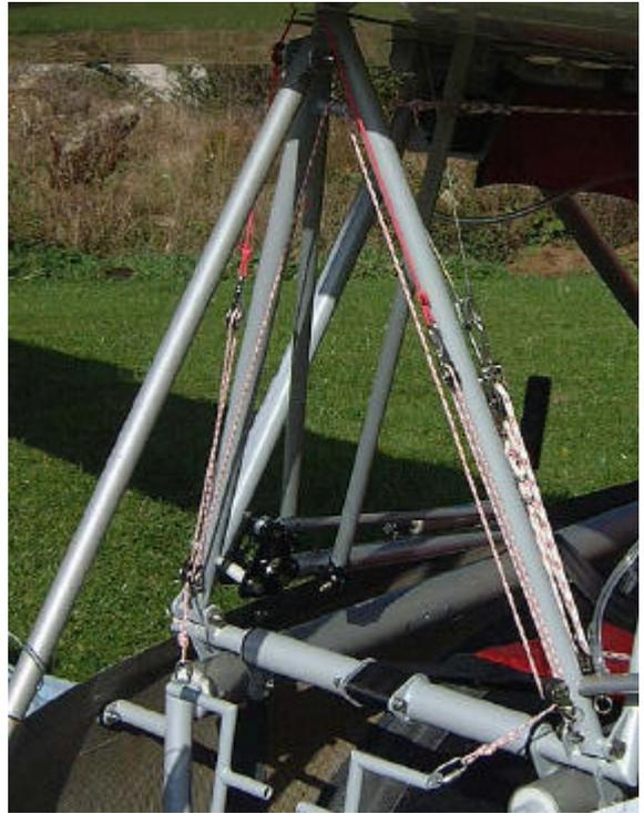
47. Connecter les câbles de palonniers. **Ne pas les intervertir** : le câble issu de l'aile gauche est branché sur le palonnier gauche.
