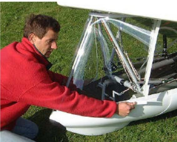
72. Tendre le pare-brise et engager les velcro en progressant le long du carénage.
