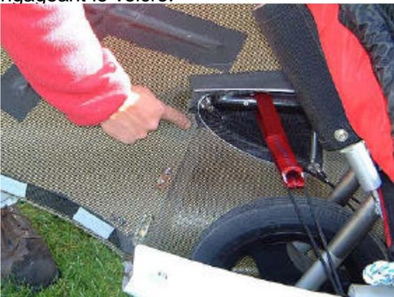
52. A partir de l'angle arrière, suivre le bord arrière du puits de roue vers le centre en engageant au fur et à mesure le velcro.
