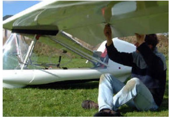
77. Brancher les commandes de flaps (la commande doit être réglée entre 0° et 15 ° pour que la connection soit aisée).
