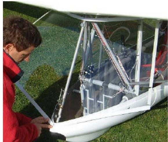
71. Positionner la pointe du pare-brise avant de commencer à engager les velcro.
