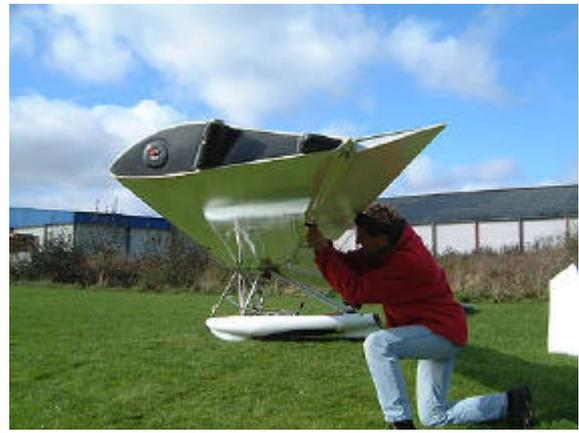
30. Connecter les élevons sur leur bielle avec un axe et un anneau de sécurité. Les élevons doivent être connectés avant de placer les winglets (dérives). Ne pas encore connecter les flaps.
