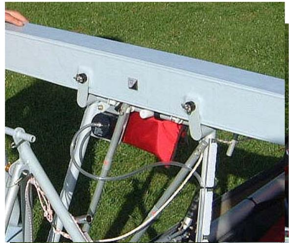
7. Pour maintenir la cellule en équilibre avant le montage des ailes, placez une serviette moirée de queue. Dans ce cas, assembler les 2 parties du cône de queue.
