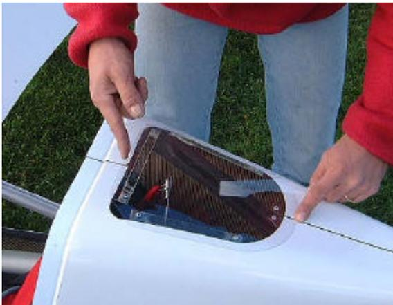
58. Mettre en place la fenêtre de parachute rangée sous l'appui-tête. Verrouiller le support de parachute.
