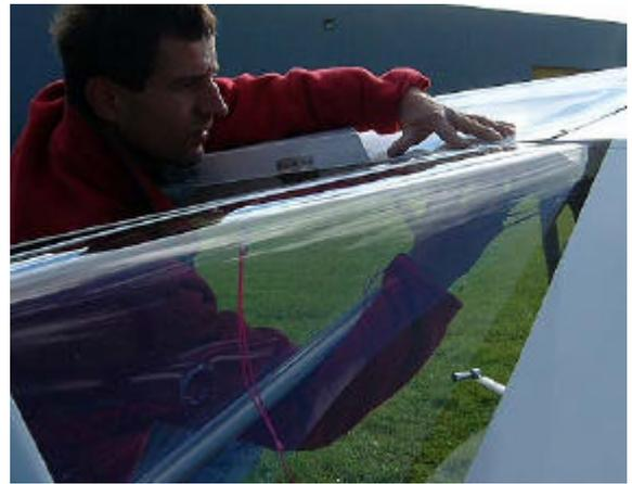
63. Mettre en place les rabats des vitres sur le bord de fuite des ailes de manière à ce que les vitres soient dans le prolongement de l'extrados.
