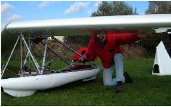
29. En tirant la commande des flaps presque à fond, retirer les axes retenant les bielles de flaps à l'intérieur de l'aile.
