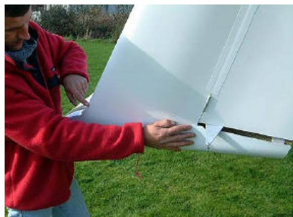
39. Aligner dans le plan vertical le bord extérieur supérieur du karman avec le velcro placé sous la charnière. Cela génère une tension qui va permettre au karman d'épouser parfaitement la forme du winglet. Engager le velcro.
