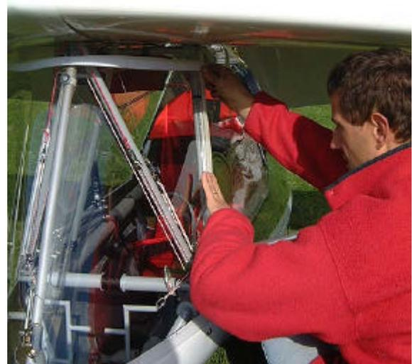
73. Progresser le long du tube vertical en pressant fermement le velcro.
