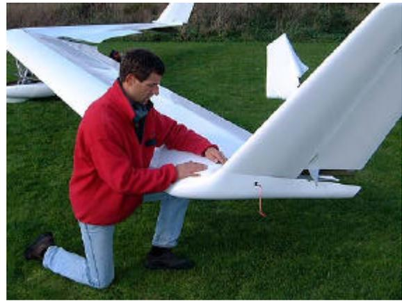
36. Appuyer l'intrados de l'aile sur un genou. Aligner le turbulateur d'extrados avec le repère correspondant sur le karman.
