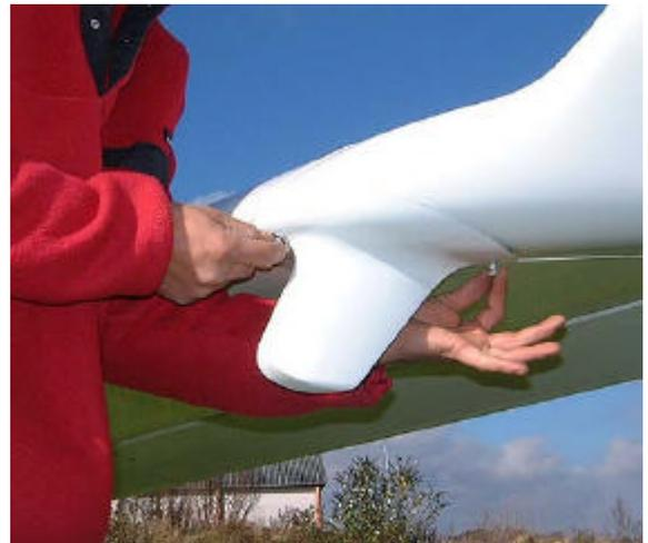
45. Placer le tiplet. Engager d'abord la vis arrière de quelques tours, puis mettre en place et visser à fond la vis de bord d'attaque. Serrer alors la vis arrière à fond.
