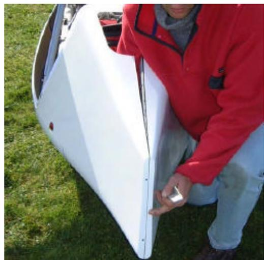
55. Mettre en place les pions à l'arrière du cône dans les ouvertures correspondantes puis assembler les demi-cône entre le puits de roue et l'arrière.
