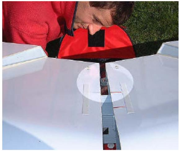
24. ... et faciliter ainsi la mise en place de l'axe arrière solidarissant les 2 ailes. **Mettre l'anneau de sécurité immédiatement.**
