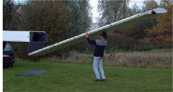
6. Lorsqu'on a trouvé le point d'équilibre, déposer le bout d'aile sur le plancher correspondant puis faire glisser l'aile.
