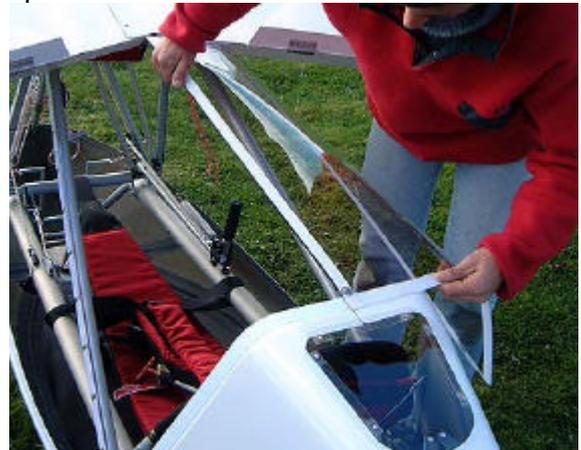
59. Présenter la fenêtre arrière droite en alignant son angle droit avec l'axe de symétrie du cône de queue.
