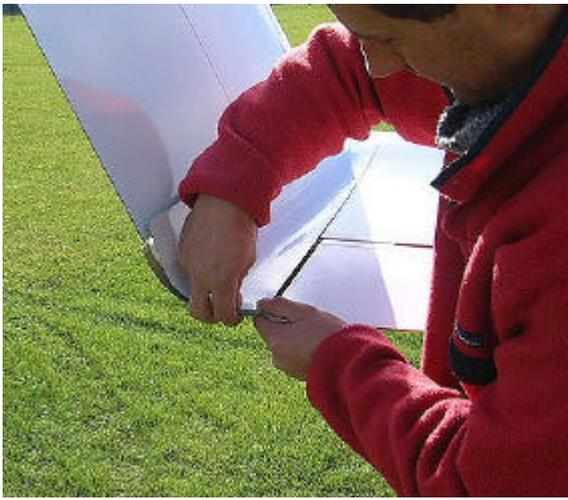
40. Fermer le velcro arrière horizontal du karman en veillant à ce que les 2 peaux soient parfaitement parallèles avec l'élevon.
