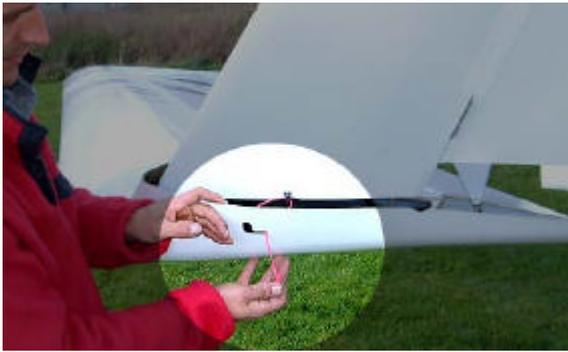
35. Présenter le karman de winglet. Passer le câble de commande à travers l'ouverture prévue.
