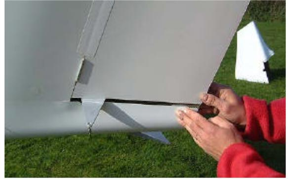
41. Fermer le velcro arrière vertical du karman en veillant à ce que les peaux soient parfaitement parallèles avec le volet de winglet.
