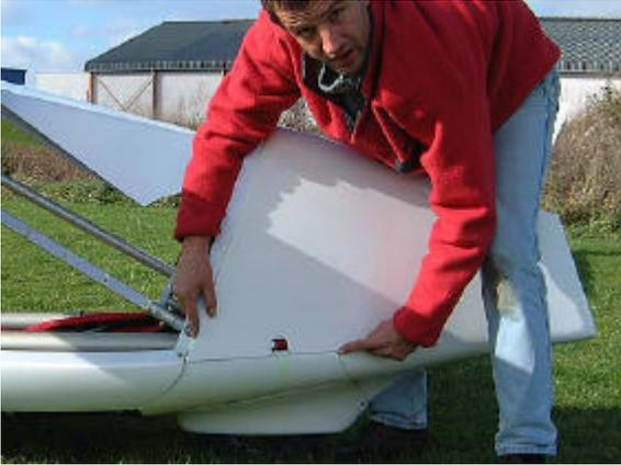
50. Présenter la partie gauche du cône de queue. Positionner d'abord l'angle arrière sur le puits de roue puis suivre le bord inférieur vers l'avant en engageant le velcro.
