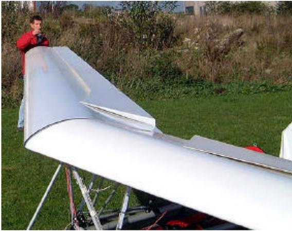
23. En faisant le tour de l'aile, donner une petite impulsion au bout d'aile vers l'arrière, pour serrer les 2 ailes l'une contre l'autre ...
