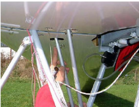
27. Connecter les biellettes de commande d'élevon au manche avec un axe sécurisé par un anneau. L'anneau de sécurité est orienté vers l'arrière pour faciliter le contrôle juste avant le décollage.
