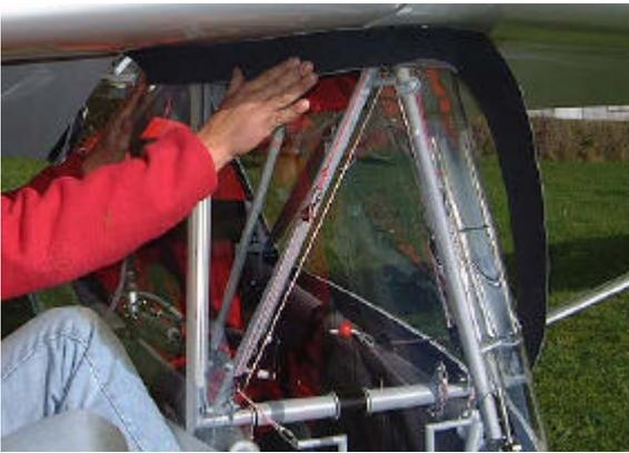
76. Engager les velcros en progressant depuis le tube avant en s'alignant sur le velcro des fenêtres.
