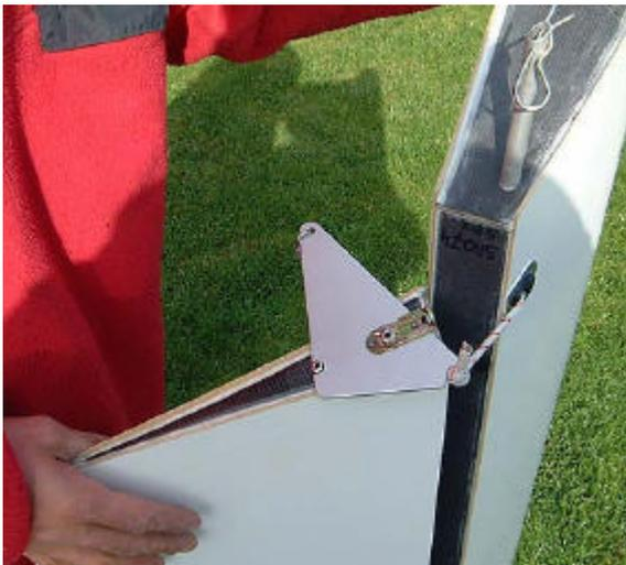
31. Monter le guignol de winglet sur son volet et engager l'élastique de rappel. Le nœud de l'élastique est orienté vers le haut du winglet.
