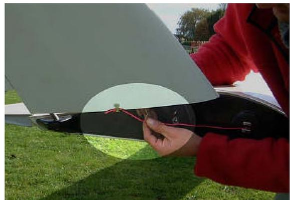
34. Passer le câble de commande de winglet à travers le pontet en inox.
