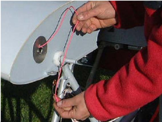
17. Aligner le doigt du cadre triangulaire avec le baguener. Commencer en poussant l'aile droite (inférieure) par le bout du câble (à l'avant) pour dégager la manille en acier.
