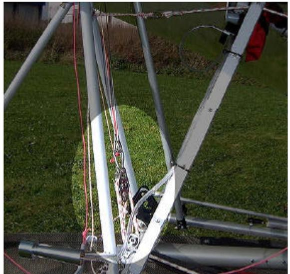
28. Connecter les câbles de flaps (volets) sur le mousqueton.
