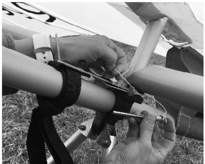
Die am Flügelrohr angekletteten Swivelrohre auf den Swivelzapfen am Flügelendrohr setzen.
