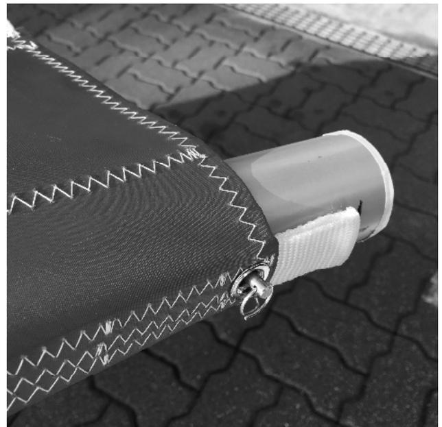
Gerät umdrehen. Packsack entfernen und die Oberverspannung mit dem Turmzapfen am Turmrohr einsetzen.
