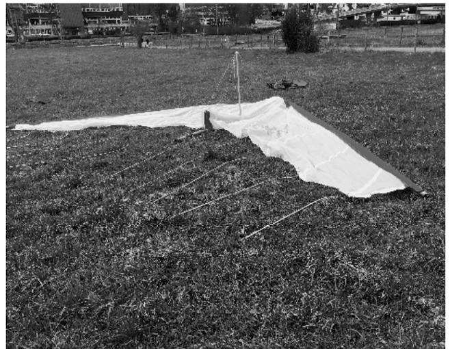
**Segelfläche ausbreiten:** Schiebe nun die Segellatten von innen nach aussen in die Segellattentaschen und sichere diese mit den Segellattenschnüren. Anschliessend kannst Du den **FLEX** an der Nasenplatte hochheben und das Zentralgelenk bis zum Turmfuss nach hinten schieben.
